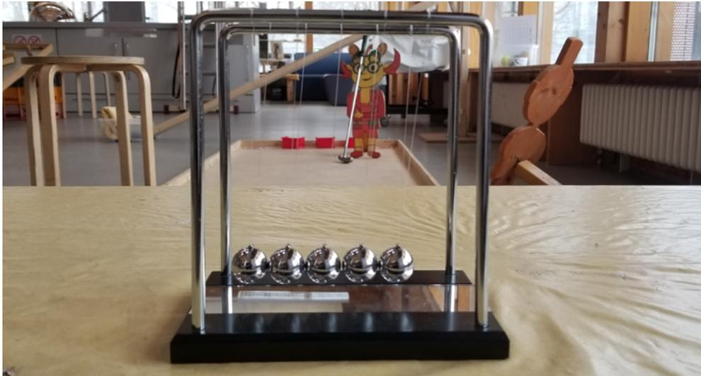
Fünf identische Metallkugeln sind an einem Metallrahmen so aufgehängt, dass sie sich in Ruhe gerade berühren: dieses Konstrukt ist auch als newtonsche Pendel bekannt. Hier befinden sich auch gradlinige Bahnen, auf denen Kugeln auf unterschiedliche Art und Weise bewegt werden können. Zum einen können große Stahlkugeln auf einer länglichen, seitlich begrenzten Ebene aus Holz bewegt werden. Weitere solcher Stahlkugeln können auf zwei nebeneinander montierten Kupferrohren rollen und bewegt werden.
