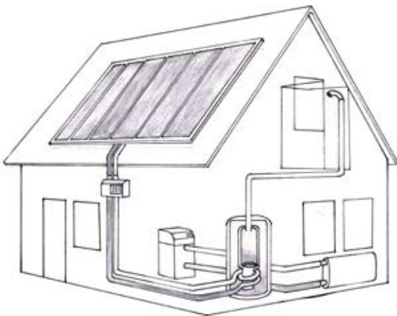
Schematische Darstellung einer Solarthermieanlage in einem Wohnhaus.
